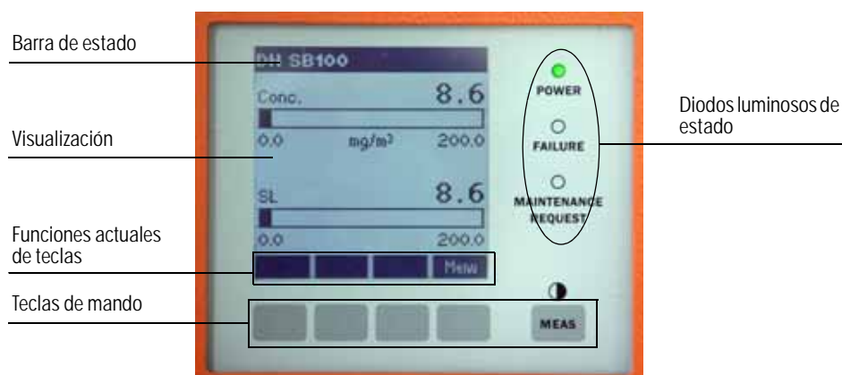
Fig. 61 Elementos funcionales de la pantalla LCD
